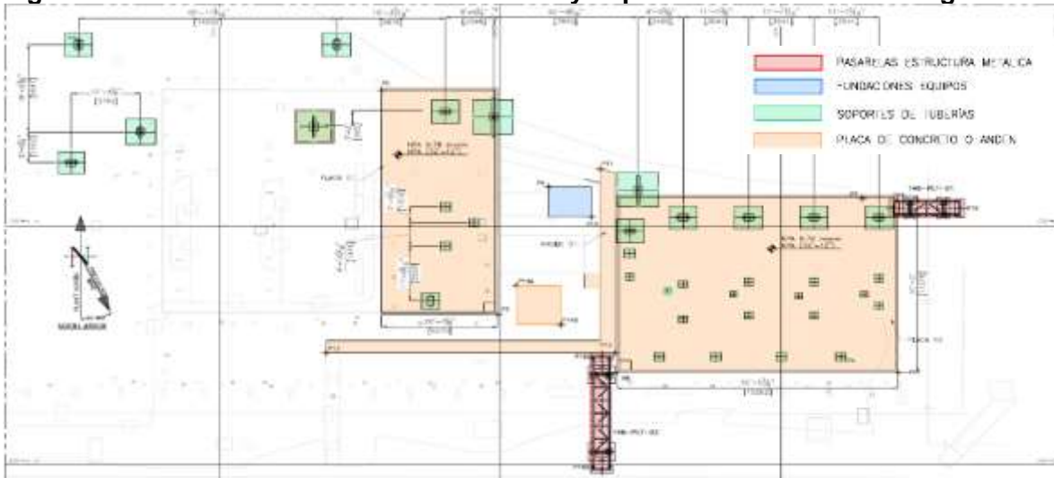
Figura 2-11 Construcción fundación bombas y soportes de tubería Blending
